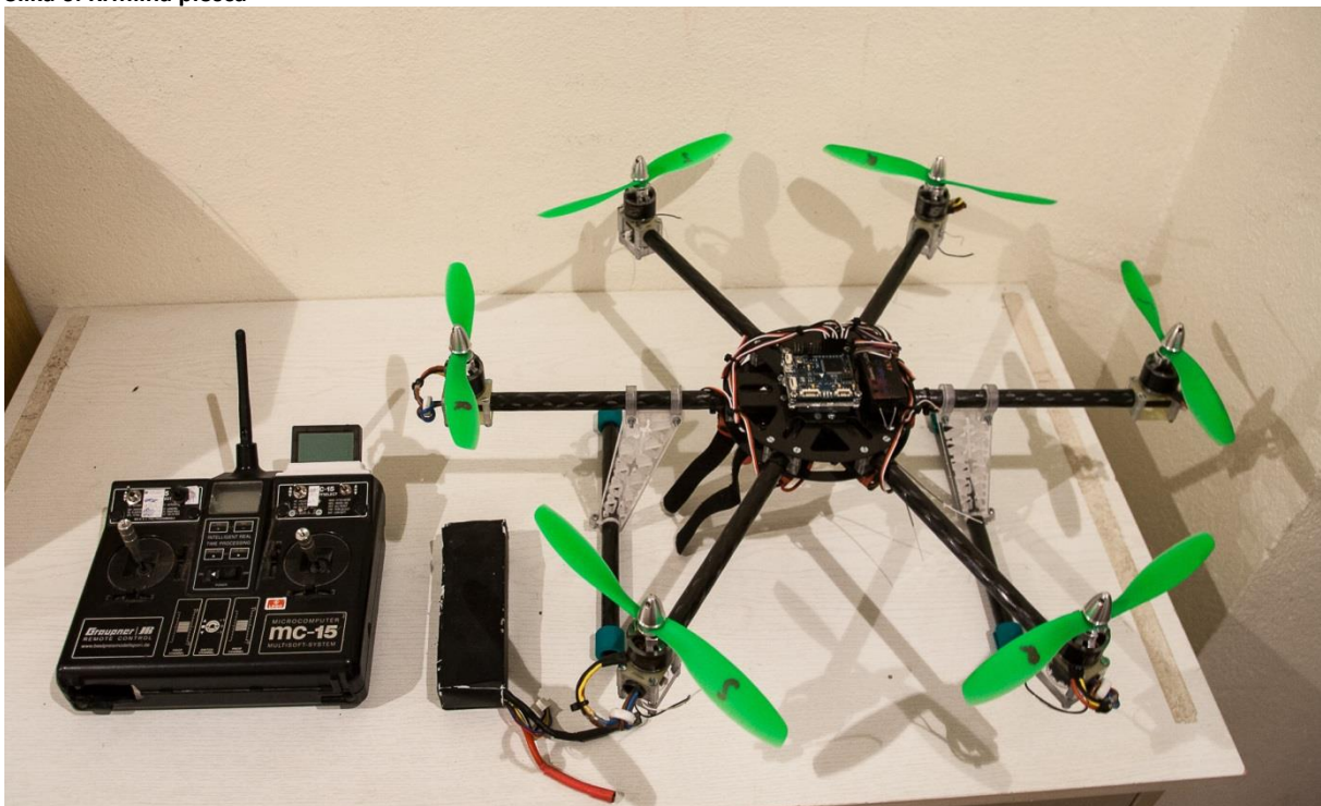
Slika 7: Radijski oddajnik (levo), akumulator (sredina) in šest-kopter (desno)
